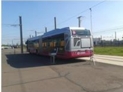
Emplacement d'essais pour les bruits extérieurs en statique
