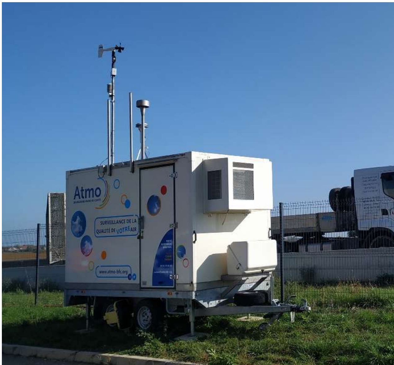
Dispositif de mesure sur la rocade – crédit photo : ATMO BFC
