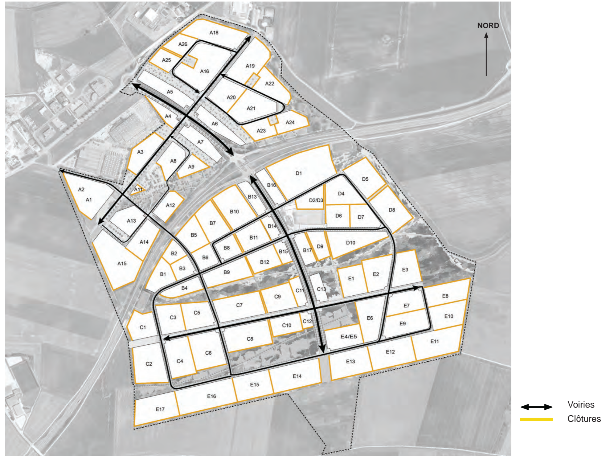
Plan de localisation des clôtures en treillis soudés - RAL 7039 ( gris quartz)
