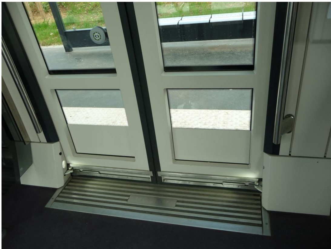
Portes avec cellules détectant la présence, et bords sensibles
