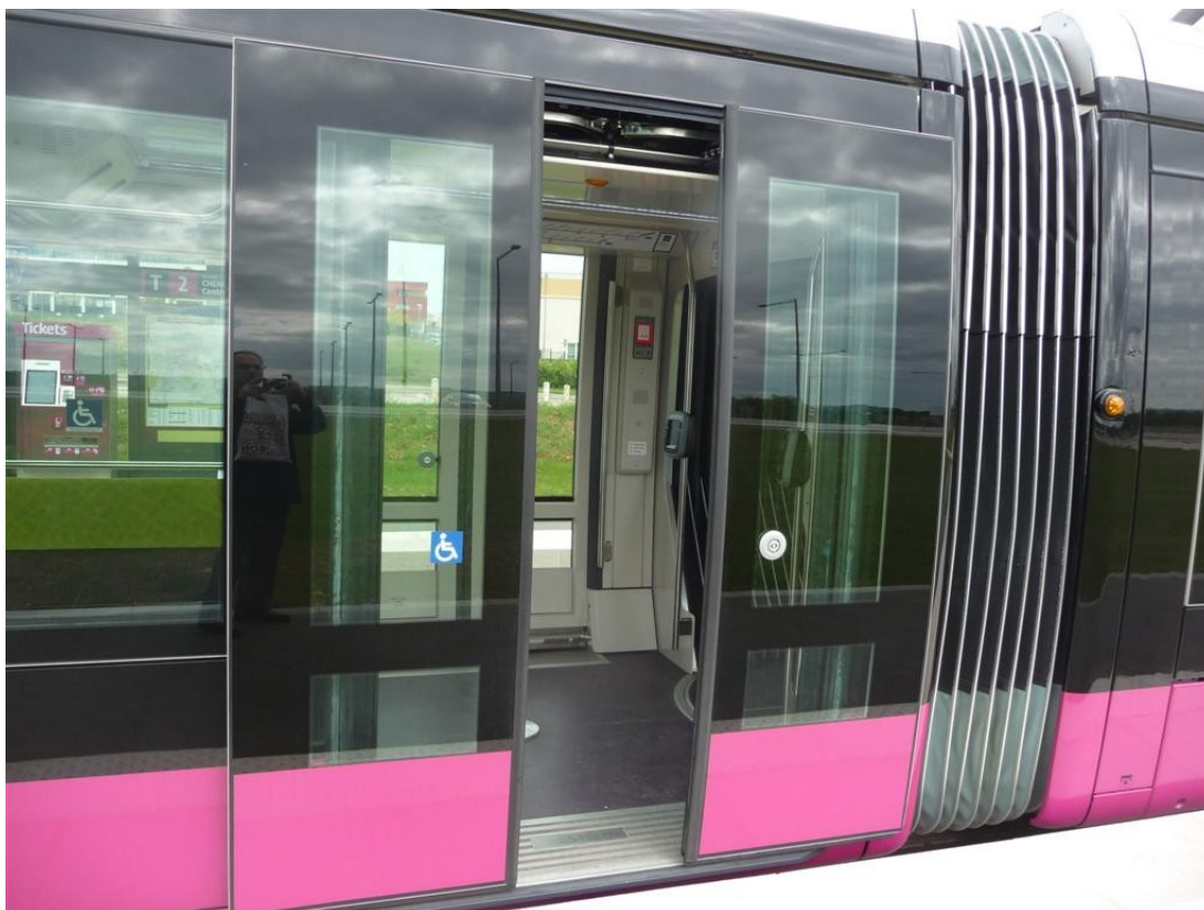
Portes louvoyantes permettant d'accéder à l'Espace Fauteuil Roulant
