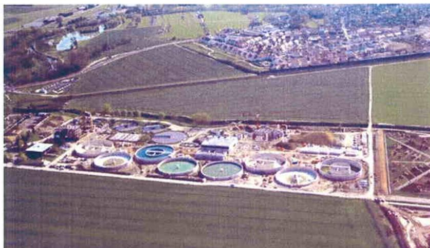
La construction d'un bassin d'orage de 30 000 m<sup>3</sup> permettra également de stocker le surplus d'eau du aux épisodes pluvieux importants afin que ces eaux polluées ne soient rejetées directement dans le Suzon puis dans l'Ouche, mais soient traitées ultérieurement.
