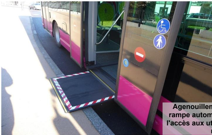
Agenouillement du véhicule et rampe automatique pour faciliter l'accès aux utilisateurs de fauteuil roulant.
