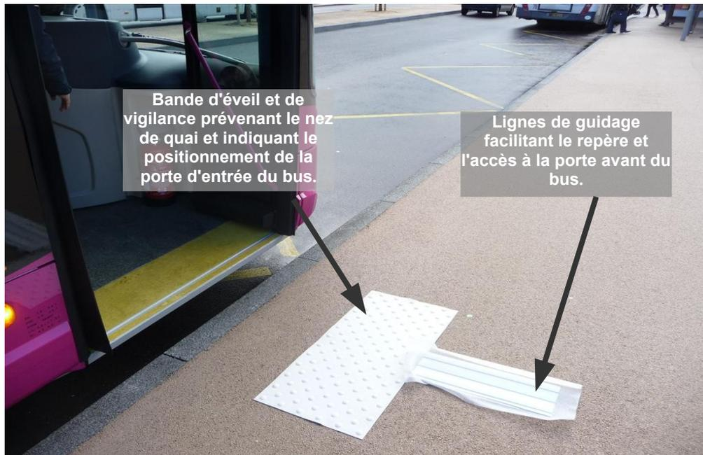
Le repère à destination des déficients visuels a vocation à être positionné au niveau de la porte avant du bus.
